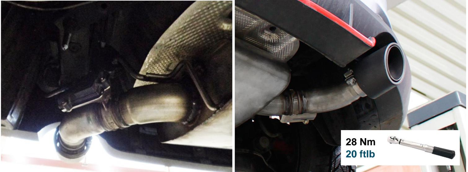
Klemm- oder Schraubverbindungen locker vorziehen. Die REMUS Abgasanlage ausrichten und die Verbindungen fest anziehen. Motor kurz anlassen und den komplette REMUS Anlage auf Dichtheit überprüfen. Sämtliche Bauteile, sowohl im kalten als auch im betriebswarmen Zustand auf Funktion und genügend Freigängigkeit überprüfen. Achten Sie dabei auf einen ausreichend belüfteten Montageaum.
